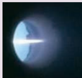
高能量密度等离子体发出的极紫外线，可用于下一代光刻技术
